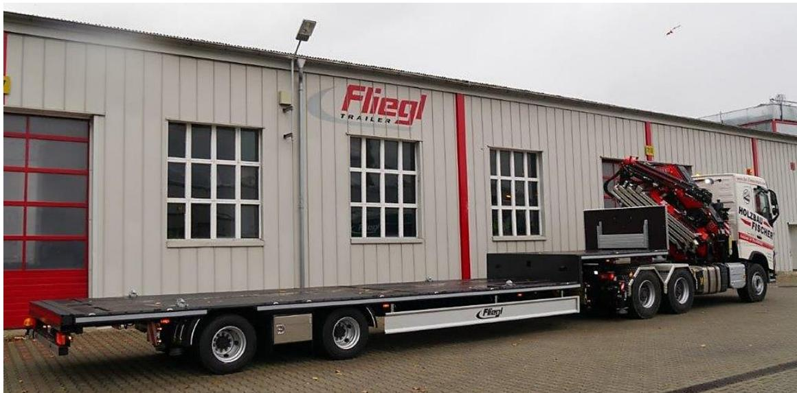
Natürlich ist der Auflieger an die speziellen Kundenbedürfnisse angepasst. So lässt sich für den Transport der oft sehr langen Wandelemente der Heckausschub (samt Unterfahrerschutz und Beleuchtung) des Sattelauflegers mechanisch um etwa 1,5 m herausziehen und alle 50 cm arretieren. Bei einer Verlängerung um 50 cm kann der Ausschub mit 2000 kg über die gesamte Breite belastet werden, bei maximaler Verlängerung von 1,5 m sind 500 kg möglich.
