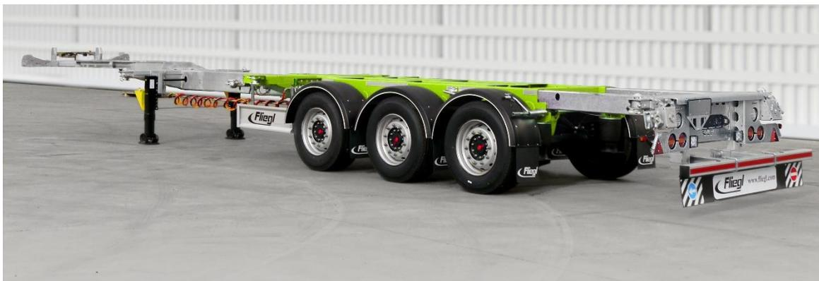
Das **Vario V3** ist mit extrem kurzem Heck-Überhang konstruiert – sein Praxisvorteil sind hervorragende **25% mehr Sattellast**.
