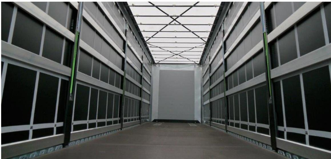
Um beim seitlichen Beladen die volle Ladehöhe zu erhalten, verwendet Fliegl seinen speziellen **Non-Elastic-Dachholm** aus hochfestem Aluminium. Dieser biegt sich auch bei geöffneten Rungen auf voller Breite nicht durch – das erleichtert das Be- und Entladen mit dem Gabelstapler enorm. Der L-Dachholm
