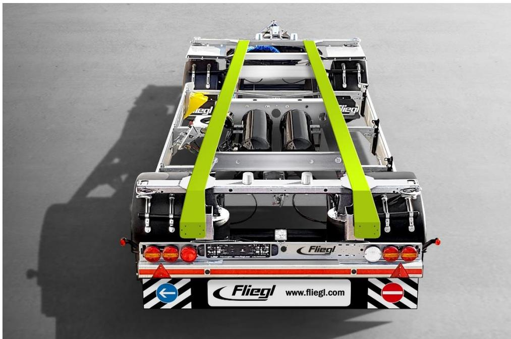
**Leichter. Besser:** In der Basisversion erreicht der Anhänger ein Leergewicht von nur ca. 2 Tonnen und punktet mit bis zu 500 kg mehr Nutzlast im Vergleich zu anderen Fahrzeugen.
