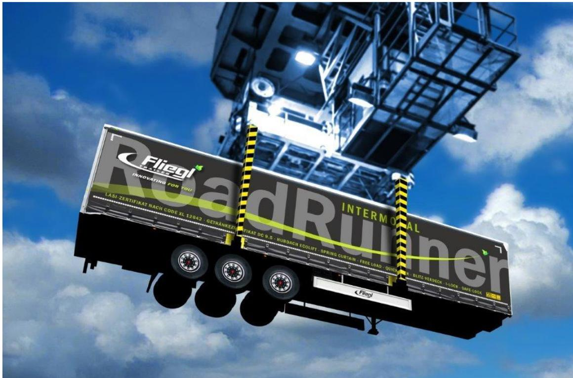
Dank Fliegls Blitz-Verdeck ist das Dach schnell aufgeschoben; um beim Beladen die volle Ladehohe zu erhalten, verwendet Fliegl seinen speziellen Non-Elastic-Dachholm aus hochfestem Aluminium. Dieser biegt sich auch bei geoffneten Rungen auf voller Breite nicht durch – das erleichtert das Be- und Entladen mit dem Gabelstapler enorm.
