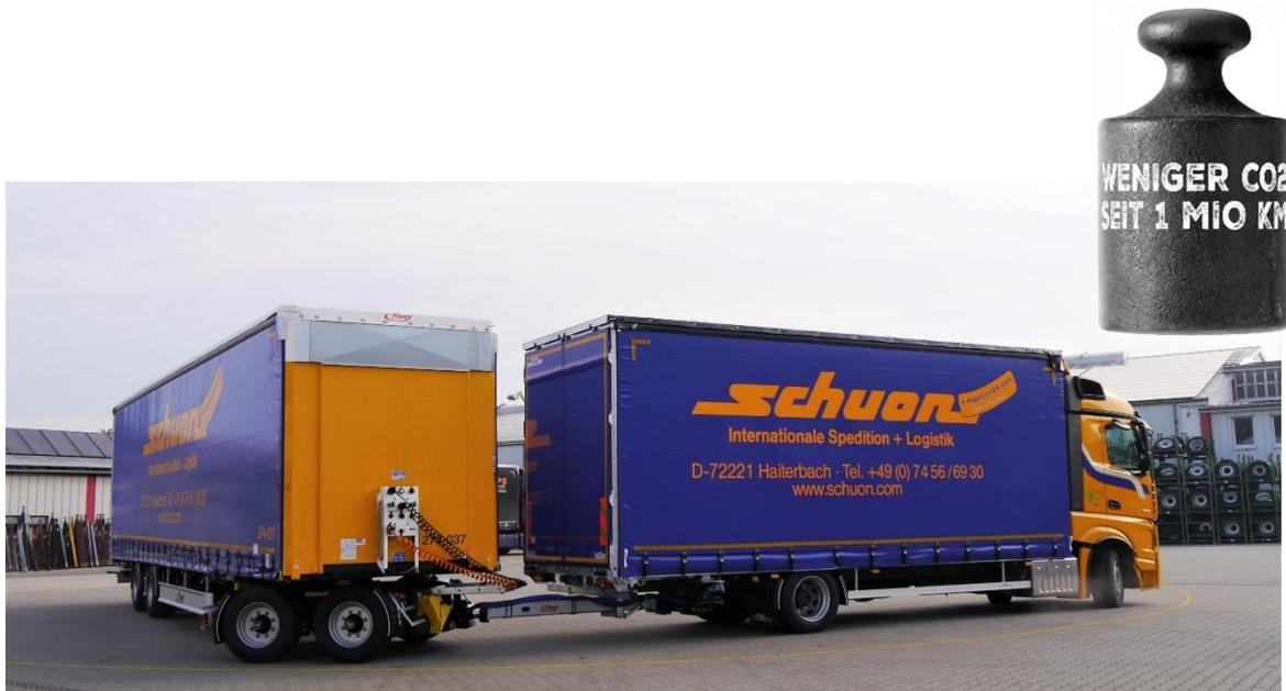
Mit nur 1300 kg ist es ca. **50% leichter** als andere Dollys auf dem Markt. Flach und kompakt konzipiert - mit dem Lenkdolly CLG schafft Fliegl einen Quantensprung im Lang-LKW-Verkehr. 920 - 950 mm Aufsattelhöhe stehen für sich und ermöglichen die Einhaltung des gesetzlichen 4-Meter-Höhenlimits.
