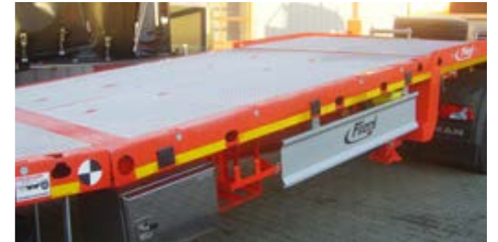
Hydraulischer Hubtisch zur Überfahrt auf den Schwanenhals mit einem Neigungswinkel von ca. 6 Grad.
