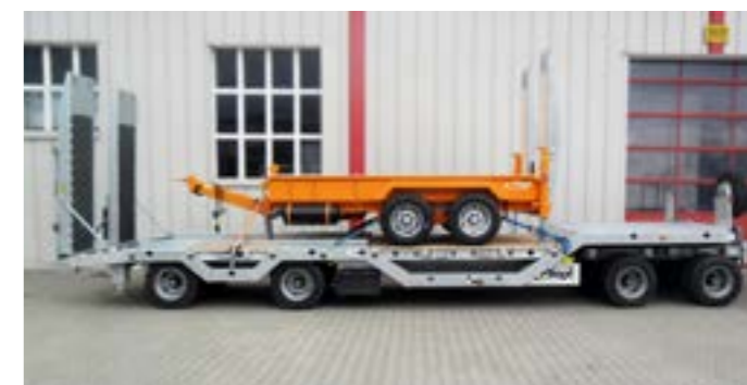
Vierachs-Tiefladeranhänger mit zwei Paar Radmulden in feuerverzinkter Ausführung.
