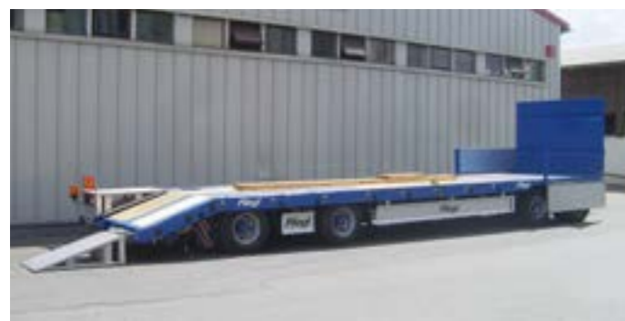
Vierachs-Tiefladeranhänger (VTS) mit gerader Plattform und ca. 980 Millimeter Ladehöhe.
