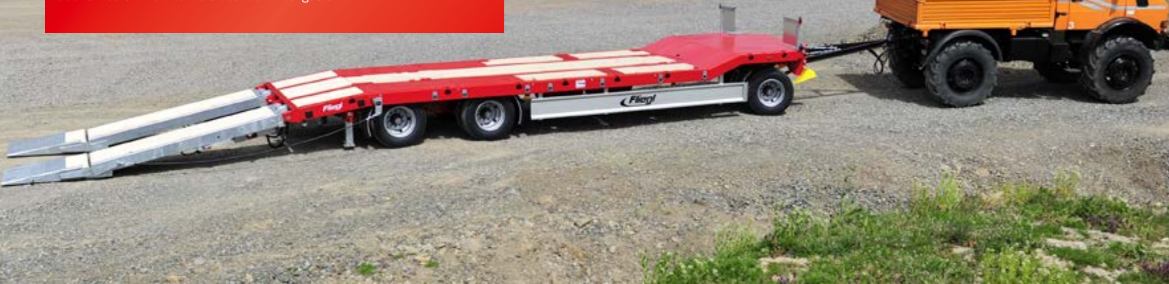
Dreiachsanhänger mit gerader Plattform und ca. 900 Millimeter Ladehöhe.
