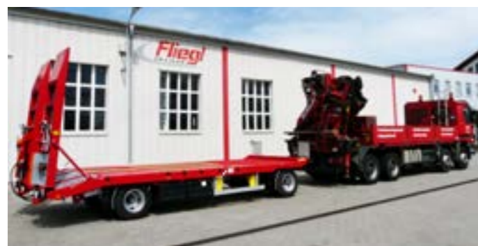
Zweiachs-Tiefladeranhänger (ZTS) mit gerader Plattform.
