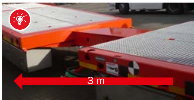
Optional ist der Liftmaster mit einer 3-Meter-Teleskopierung erhältlich.
