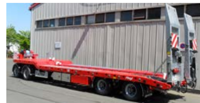
XL-Ausstattung mit hydraulischer Seilwinde, Rückfahrkamera, Gitterrostbelag, vielfältigen Zurrmöglichkeiten etc.
