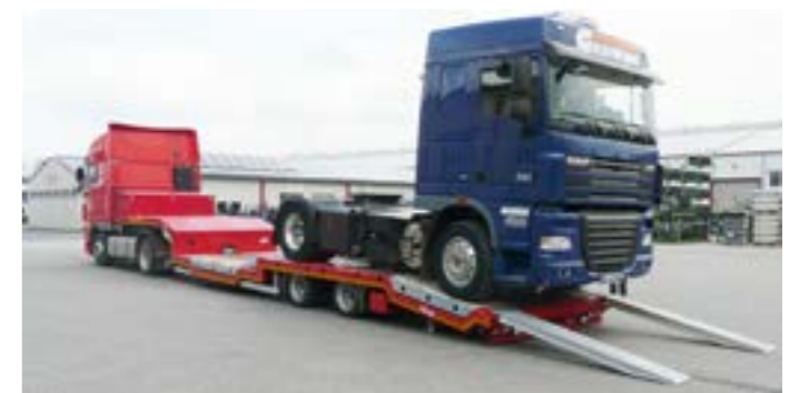
Zweiachs-Tieflader für den Transport von bis zu zwei Sattelzugmaschinen bei Überführung, Vermietung, Bergung etc.
