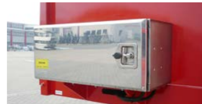
Edelstahlbehälter zum Schutz einer Seilwinde.
