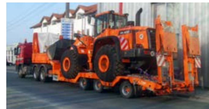
Dreiachs-Tieflader mit zwei Paar Radmulden für den Transport von Radladern.
