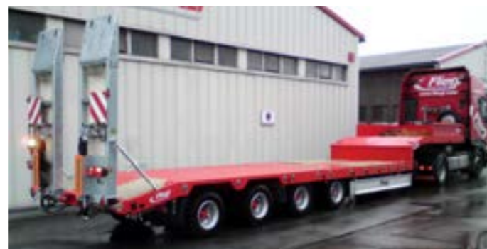
Vierachs-Tieflader mit zwei Nachlaufkachsen.
