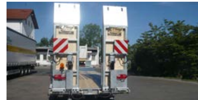
Hydraulische Rampen, mit Holz belegt, 2800 x 750 Millimeter
