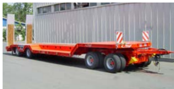
Vierachs-Tiefladeranhänger mit zwei Paar Radmulden in Export-Sonderlänge.
