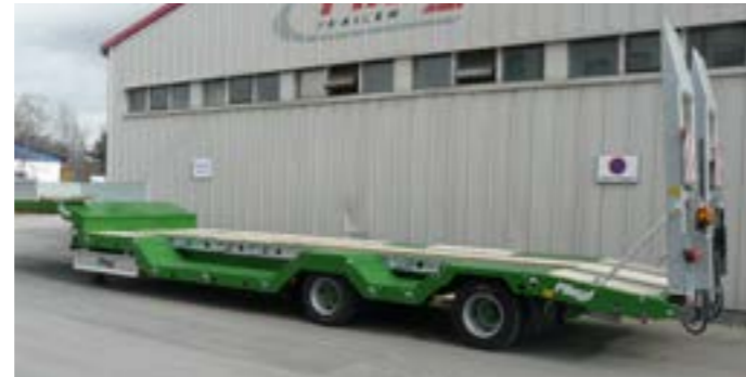
Tieflader mit zwei Paar Radmulden für den Transport von Land- und Baumaschinen.
