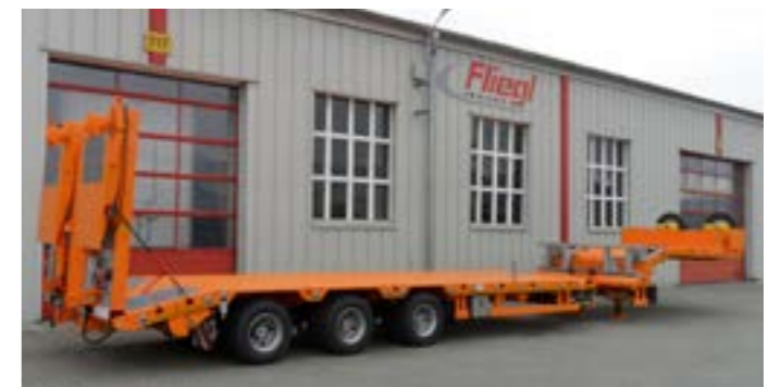
Tieflader mit hydraulischer Zwangslenkung und Teleskopierung.
