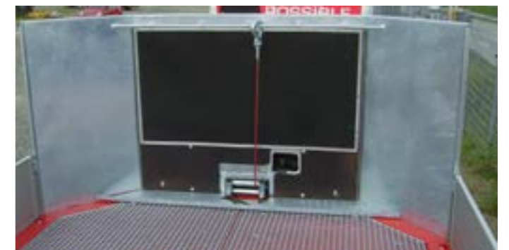
1200 Millimeter hohe Stirnwand mit Einhängeleiste für Spanngurte und -ketten.
