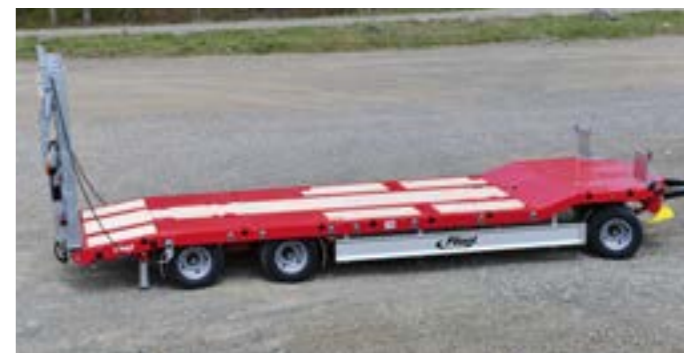
Tiefladeranhänger in gekröpfter Ausführung mit ca. 860 Millimeter Ladehöhe.
