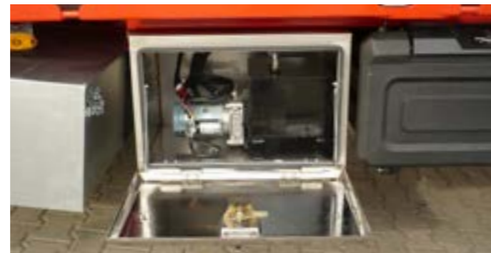
Elektrohydraulisches Aggregat zur Betätigung der Auffahrampen.
