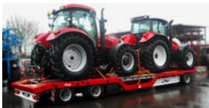
Dreiachs-Tiefladeranhänger mit gerader Plattform, Radmulde sowie Einhängeleiste für Alurampen, die mittig verstaut werden.
