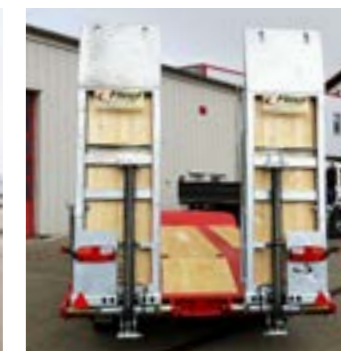
Rampen mit Holz belegt, Betätigung mittels Federheber, 2800 x 750 Millimeter
