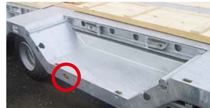
Fliegl installiert Radmulden in verschiedenen Ausführungen. Die Seitenmarkierungsbeleuchtung ist geschützt in den Außenrahmen integriert.
