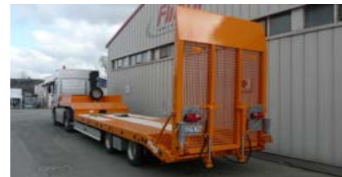
Durchgehende Auffahrrampe zum Beispiel für den Transport von Gabelstaplern.
