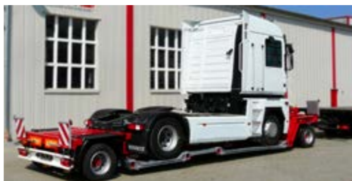
Zweiachs-Tiefladeranhänger (ZTS) für den Transport landwirtschaftlicher Maschinen und Sattelzugmaschinen.
