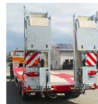
3600 x 750 mm, geteilt über Seilzugstreckung, mit Holz belegt
