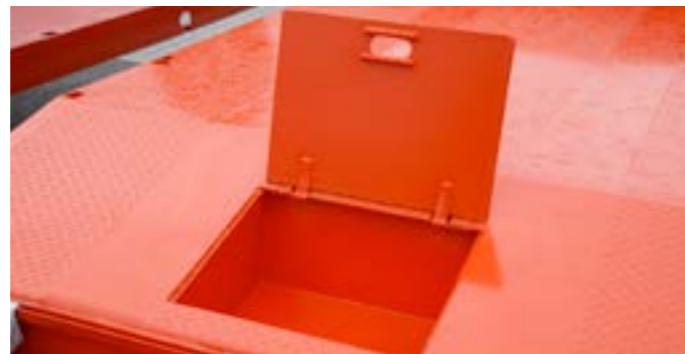
Serienmäßiger Staubbehälter in der Überfahrtschräge des Schwanenhalses
