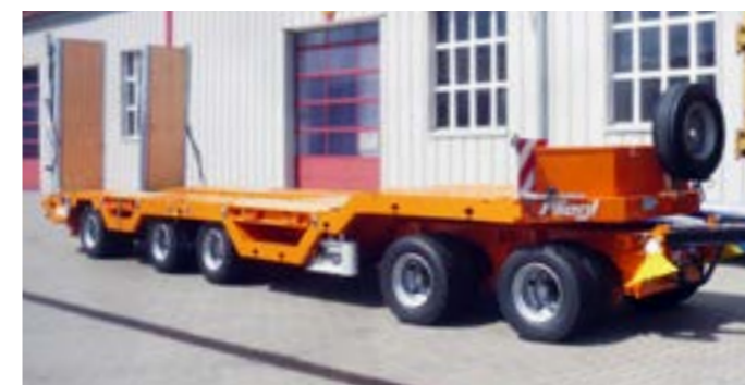
Fünfachs-Tiefladeranhänger mit zwei Paar Radmulden und einer Nachlaufkchse.
