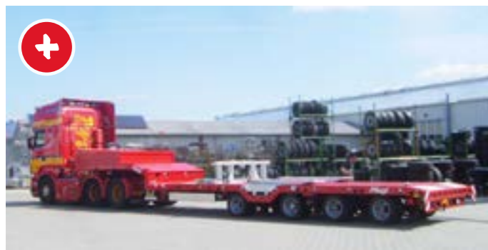
Vierachs-Tieflader mit Teleskopierung und einer Ladehöhe von ca. 820 Millimeter.
