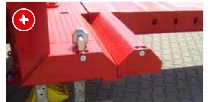
Variables Ladungssicherungssystem für steckbare Containerverriegelungen, Rungen und Ösen
