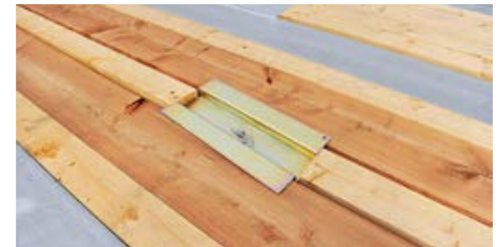
Die Holzbohlen zur Verbreiterung des Tiefbetts werden in der Mitte der Ladefläche aufbewahrt (rechts) oder optional unterhalb der Ladefläche.
