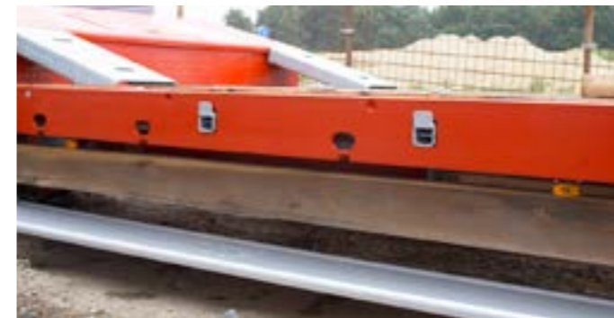
Die Holzbohlen zur Verbreiterung des Tiefbetts werden in der Mitte der Ladefläche aufbewahrt (rechts) oder optional unterhalb der Ladefläche.
