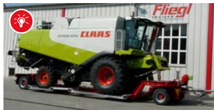
Zweiachs-Tiefladeranhänger (ZTS) für den Transport landwirtschaftlicher Maschinen und Sattelzugmaschinen.
