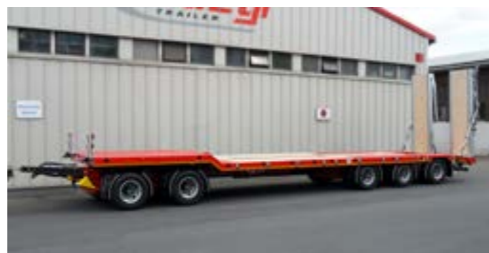
Fünfachs-Tiefladeranhänger (FTS) mit Nachlaufkchse.
