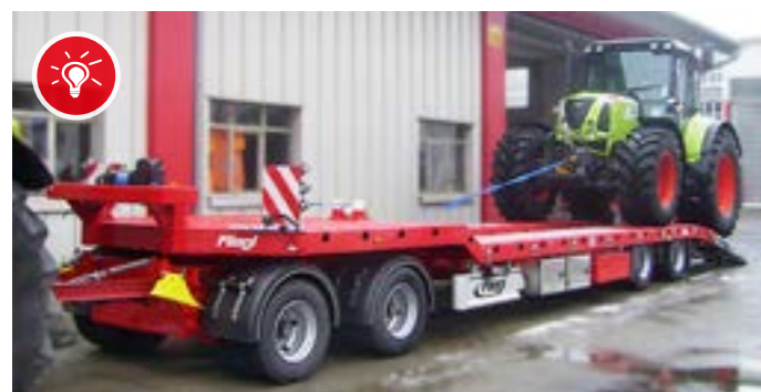
Tiefladeranhänger mit Seilwinde.
