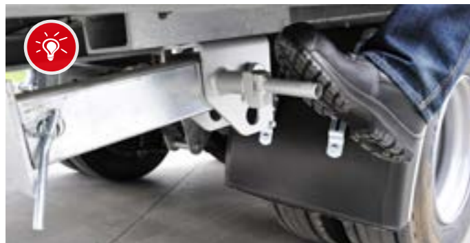
Mechanische, klappbare Heckabstützung mit komfortabler Fußbedienung
