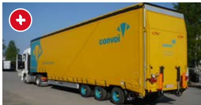
Tieflader mit Schiebegardine zum Schutz sensibler Ladung und für Einsatzflexibilität.
