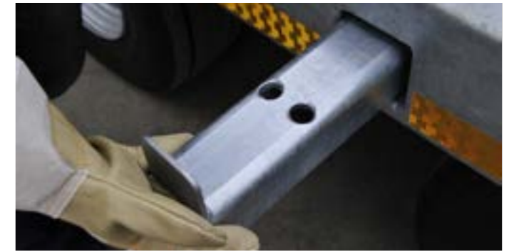
Teleskopierbare Ausschübe für Ladeflächenverbreiterung auf 3 Meter ...
