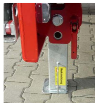
Mechanische, klappbare Heckabstützung
