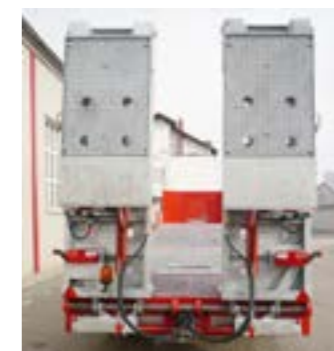
Rampen für den Fliegl Liftmaster, mit verzahntem Gitterrost belegt, hydraulisch seitlich verschiebbar, 4450 x 850 Millimeter
