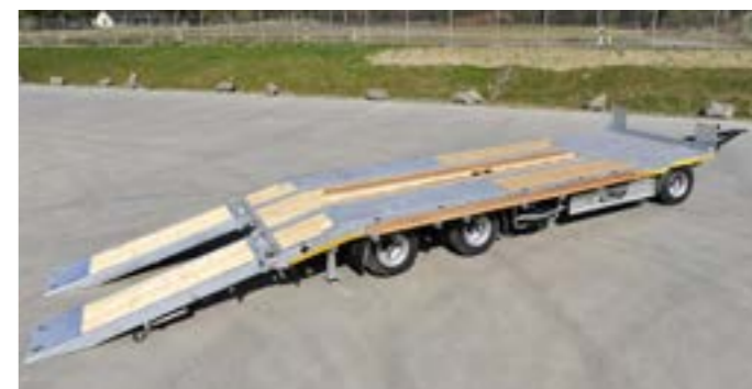
Dreiachsanhänger mit gerader Plattform und ca. 900 Millimeter Ladehöhe.
